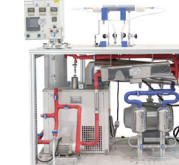
투과증발 분리막 시스템 Pervaporation system 25p
