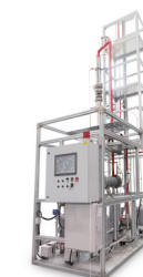
추출 공비 증류 시스템 Extractive distillation system 29p
