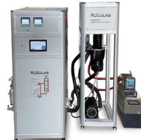
자기식 밀도 측정기 Magnetic suspension balance 12p
