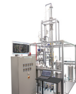
분리막-증류 융합 시스템 Membrane-distillation hybrid system 27p
