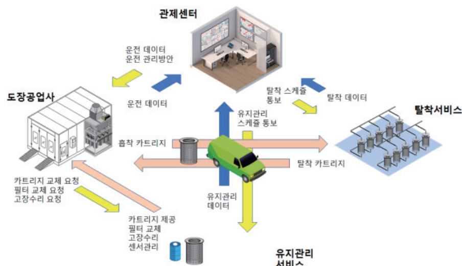
그림 2. 자동차 도장시설에서 배출되는 VOCs 저감설비에 대한 공동관리 서비스 모델
